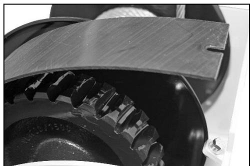
Voor het goed laten functioneren van de lastdrukrem moet de lier minimaal met ca. 5% van de nominale last belast worden.
