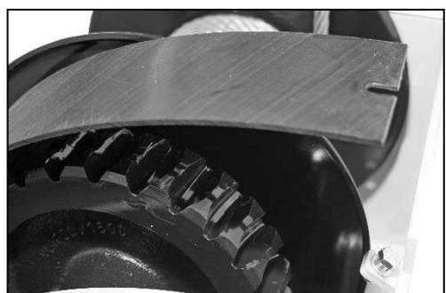
Für ein gutes Funktionieren der Lastdruckbremse muss die Winde zumindest mit ca. 5% der Nominallast belastet werden.
