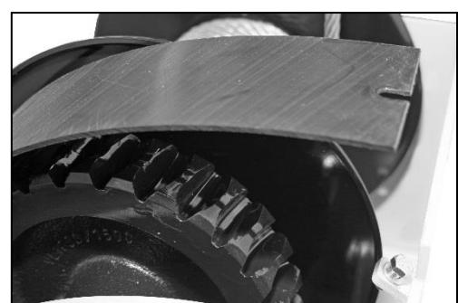
**Controler avant chaque utilisation si le transfert est encore assez graissé. Cela empêchera "grippage" et une surchauffe.**
