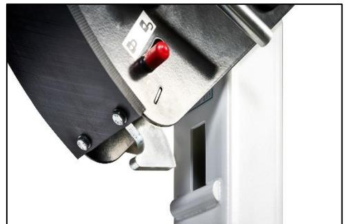
Montieren Sie den Haken in das Loch der Mast und spannen Sie das Seil damit Sie die Kurbel in die Uhrzeigerrichtung drehen.
