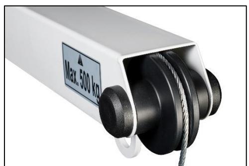
Demontieren Sie die Schutzhülle vom Hebedavit. Diese Kappe ist gesichert mittels vier M6 Sechskantschrauben.
