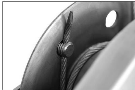
Die Befestigung des Seils erfolgt mittels der aufgebauten Seilklemmen.
