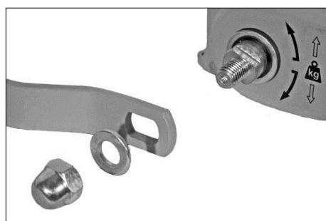
Alle moeren van de bevestigingsbouten in gelijke mate vastdraaien en borgen.
